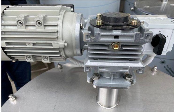
Der Motor und das Getriebe des Rührwerks dem Schalter
